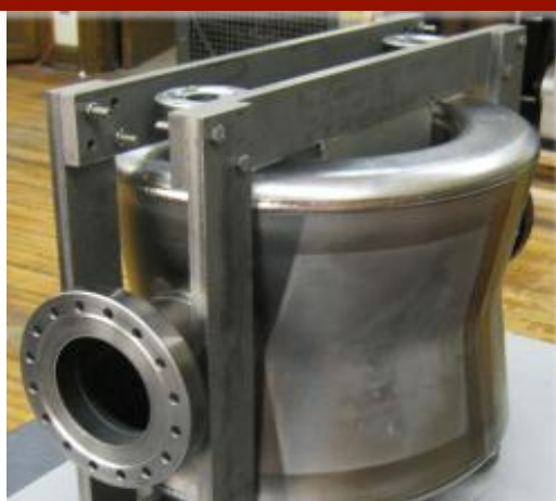
DQWR prototype (17-Jan-2013) [BNL]
